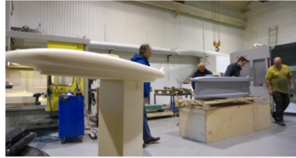
TESTMODELLER: Terje Lade (blå jakke) og hans hjelpere på modellverksted Shape. Til venstre står overbygget til modellen som skal testet i modelltank. Den grå modellen til høyre er brukt til testing i vindtunnel. Ogne Øyehaug
