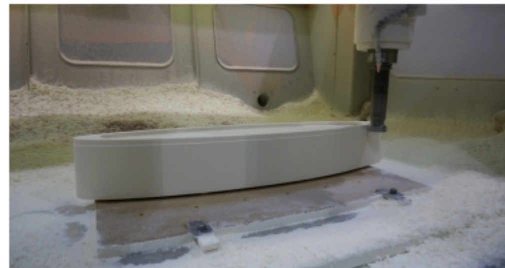
TAR FORM: Hovedelen av skroget til den første modellen som skal testet i modelltank freses ut. Ogne Øyehaug
